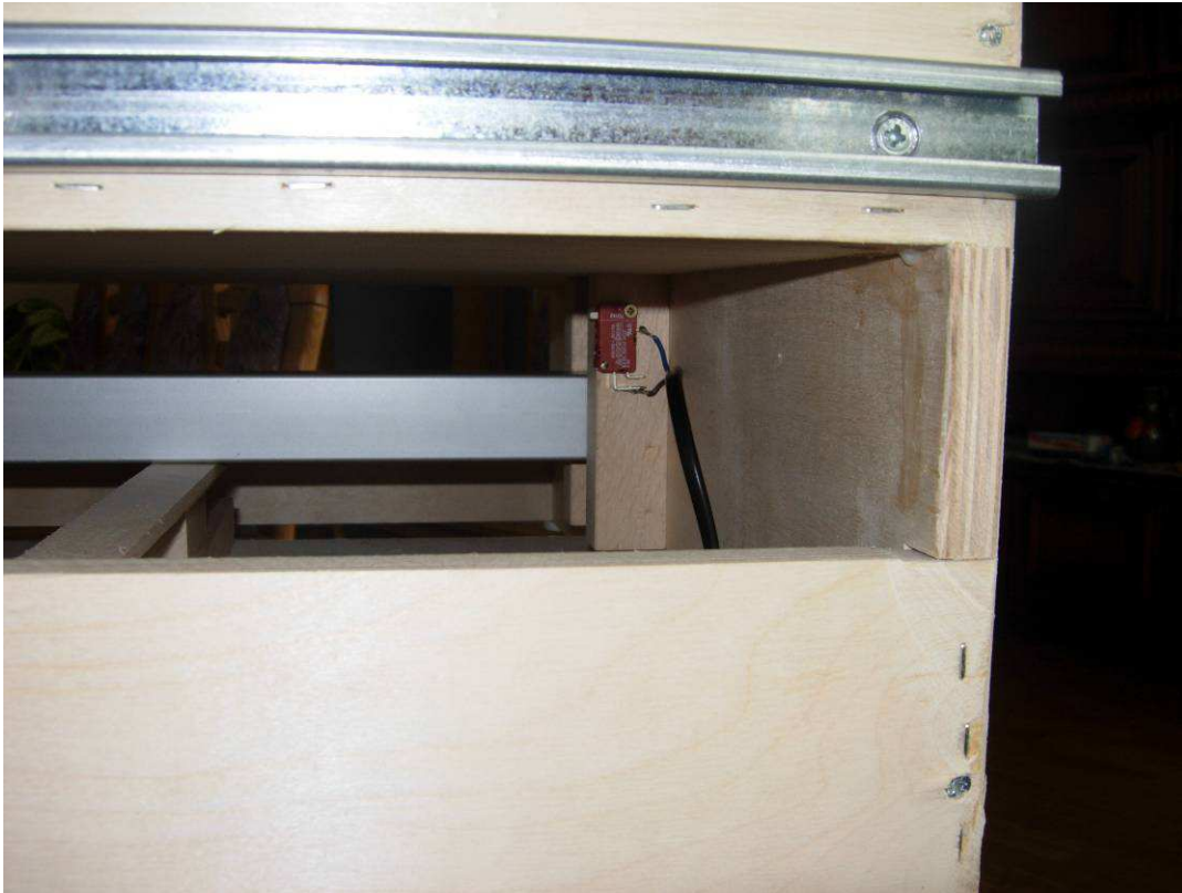
Not- ausschalter für die X-Achse an der Tisch Unterseite
