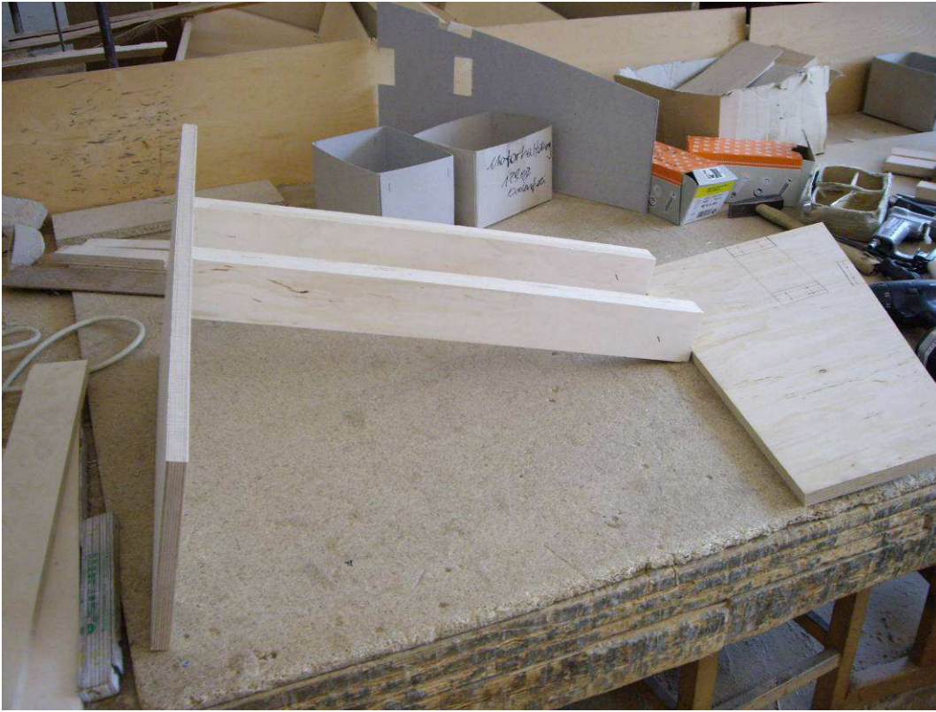
Zusammenbau des Portals in 18mm Sperrholz
