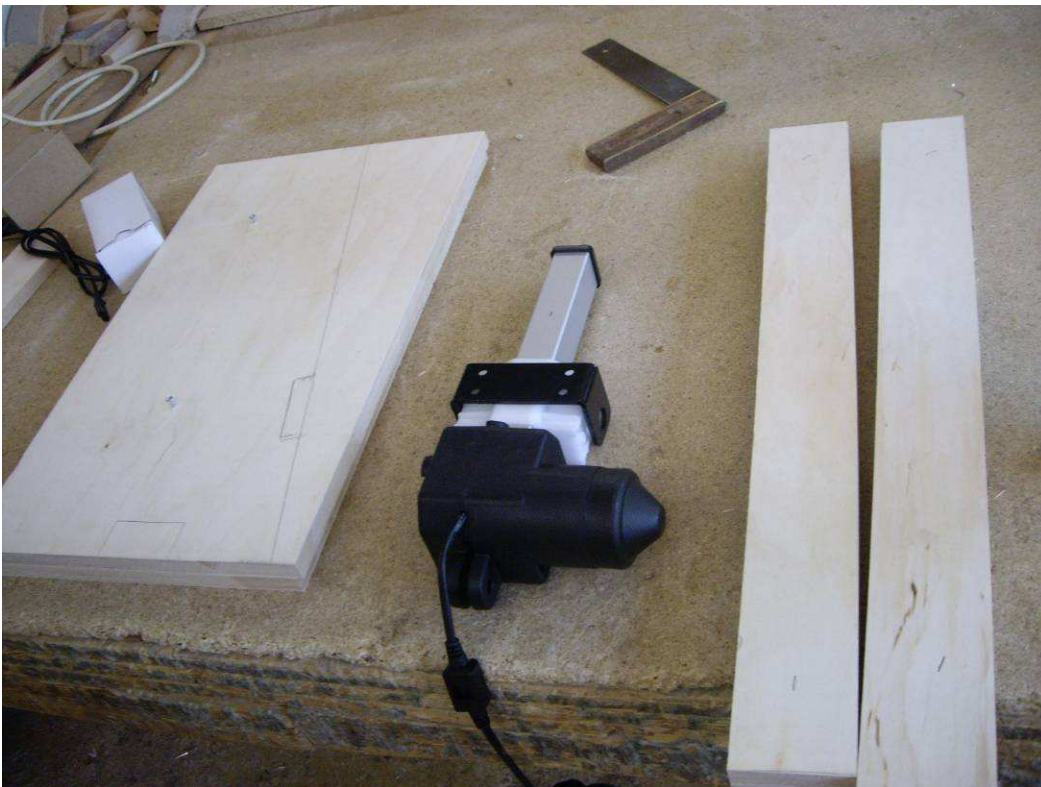
Führungsmotor des Fräserkopfes
