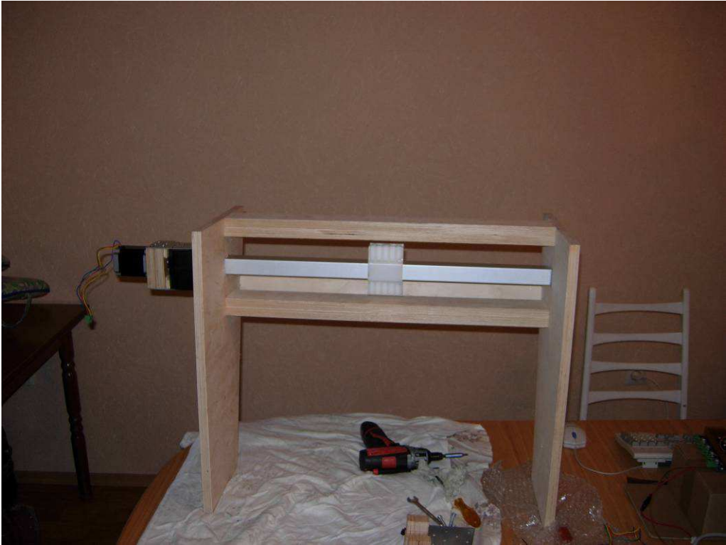
Portal mit Spindeltrieb und Motor
