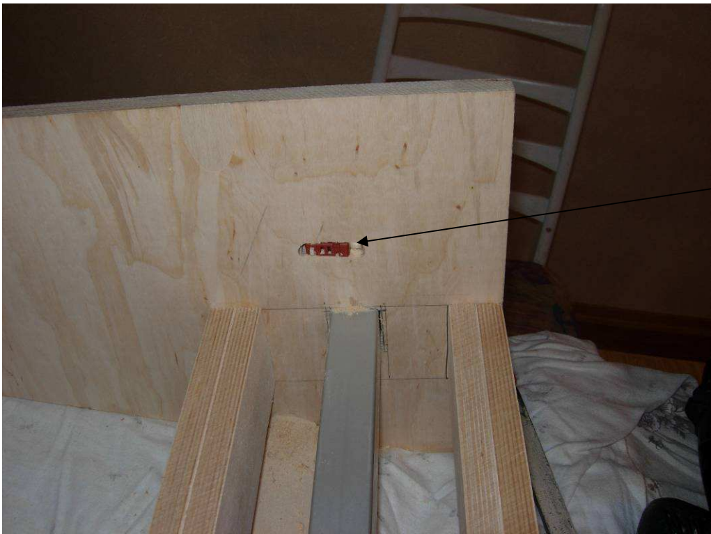
Probeloch für den Notausschalter der Y Achse
